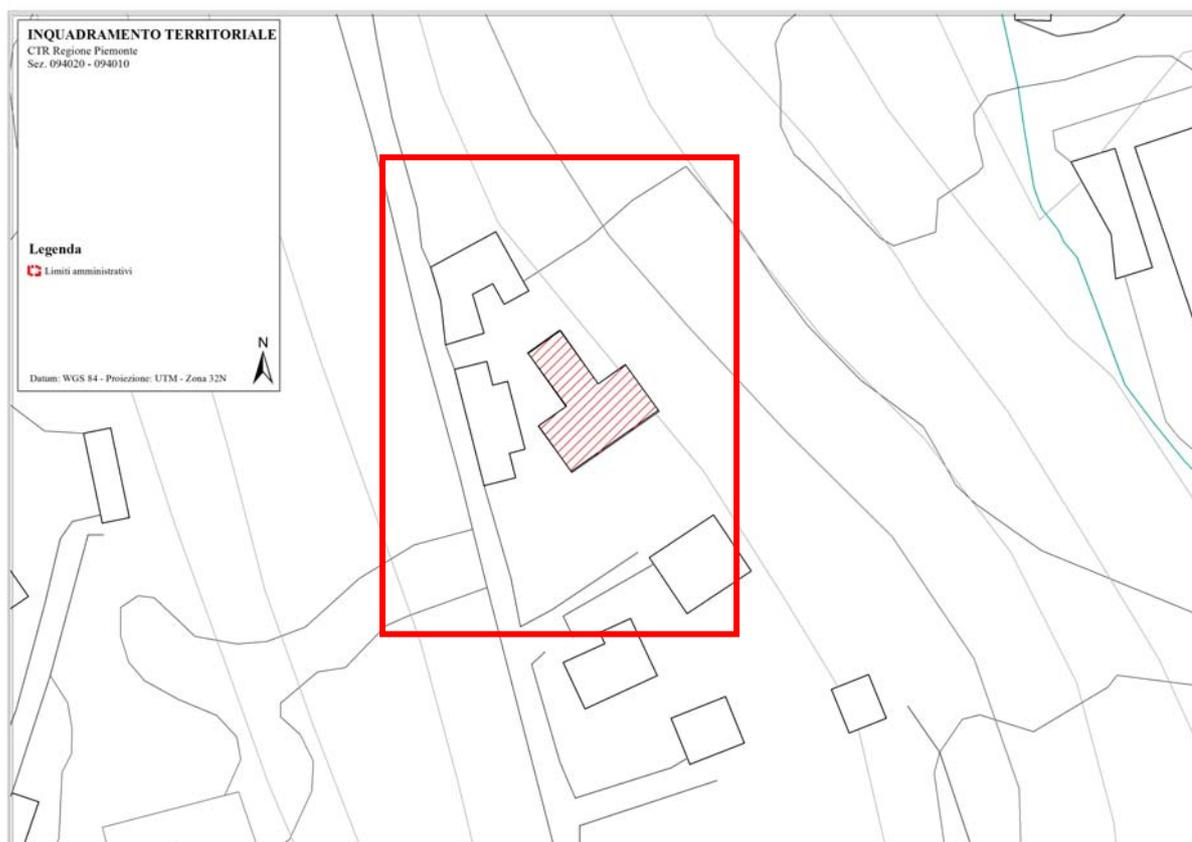
Nella cartografia riportata viene evidenziato l'edificio, tra quelli insistenti nell'area, con copertura in cemento-amianto in lastre. La superficie da rimuovere e smaltire, come da normativa in materia di rifiuti, è di circa 600 mq.
